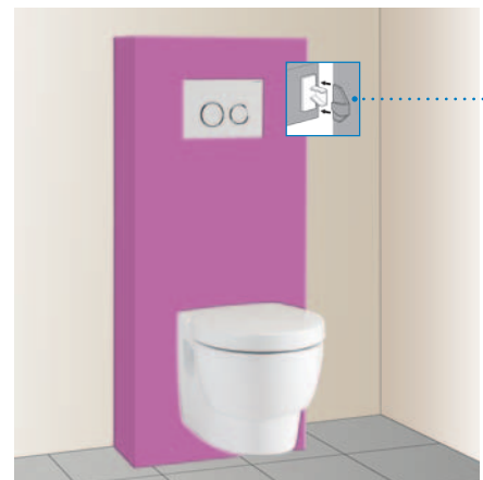
3 Fixation de la cuvette suspendue et de la plaque de déclenchement.
