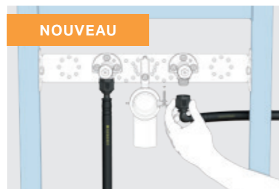
Raccord de transition Geberit avec MasterFix pour le contrôle clairement audible d'une bonne installation.
