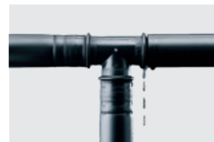
Non sertis, non étanche. Les chemins de fuite définis permettent de voir immédiatement les raccords non sertis lors du test de pression.
