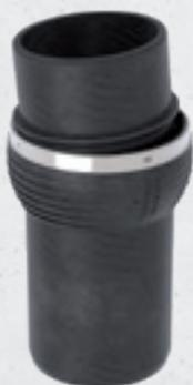
Il n'est pas toujours possible d'éviter les imprécisions lors de la construction. Avec le raccord à décalage Silent-db20 de Geberit, les raccords peuvent être raccordés efficacement et sans tension avec un décalage axial allant jusqu'à 10 cm. Il est ainsi possible de réduire d'un tiers le temps d'installation par rapport à une installation avec des coudes de 15°, 30° ou 45°.
