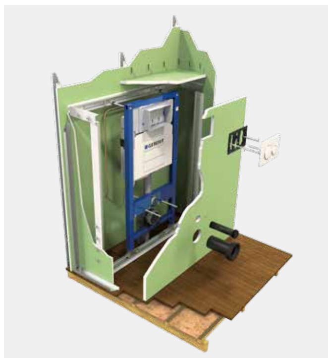
Pose* d'un bâti-support WC sur sol plancher bois traditionnel en applique sur cloison à ossature métallique, à hauteur partielle.
