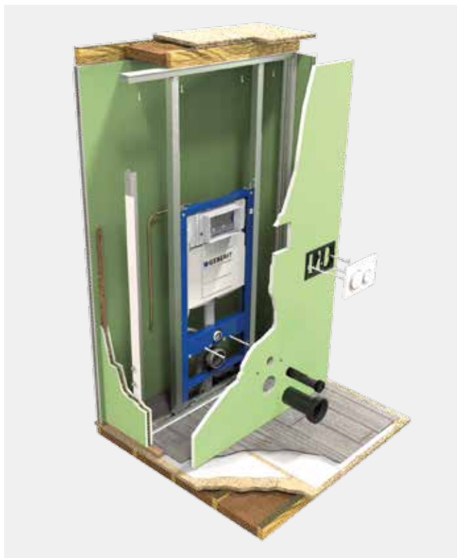
Pose* d'un bâti-support WC sur plancher aggloméré en applique sur cloison alvéolaire, à hauteur du local.
