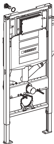
Illustration 5: Bâti-support Geberit Duofix pour WC suspendu, avec réservoir à encastrer Sigma, pour l'aspiration des odeurs avec évacuation d'air
