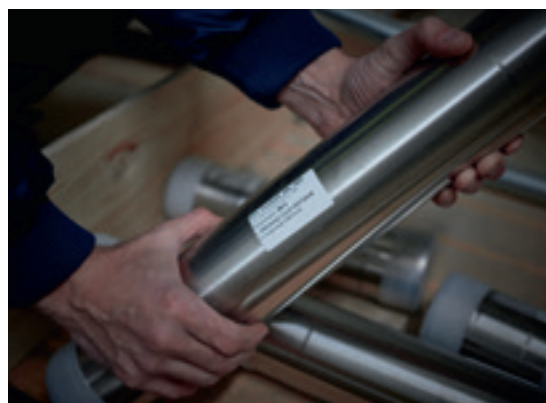
Installation facile grâce à un étiquetage cohérent et clair des tronçons de réseau coupés à longueur.
